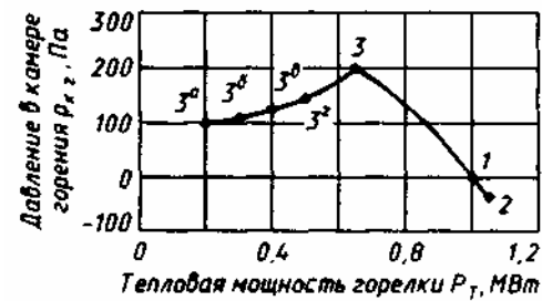
Рисунок А.2 — Пример графического изображения для горелок с многоступенчатым и плавным регулированием тепловой мощности
