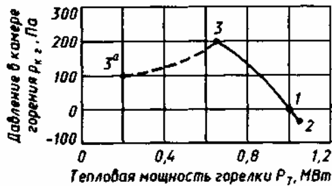
Рисунок А.1 — Пример графического изображения для горелок с двухступенчатым регулированием тепловой мощности
